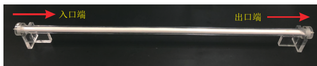
图1 驱替实验填砂管实物图
